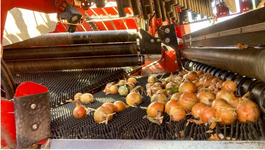
GRIMME Landmaschinenfabrik GmbH & Co. KG (Salon 25, F10 Standı) „ChangeSep“ Değişirilebilir ayırıcı
