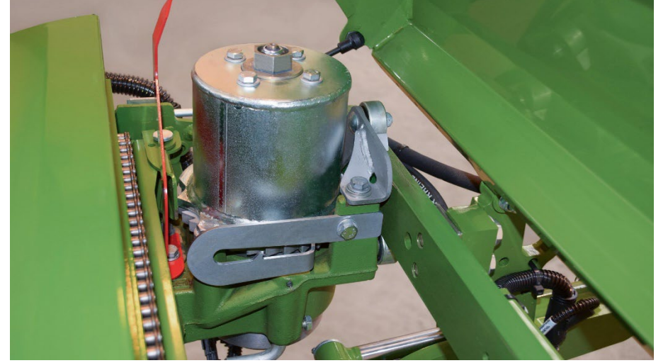
Maschinenfabrik Bernard Krone GmbH & Co. KG (Salon 27, F22 Standı) Silajlık hasat makinesinde manuel ayar gerektirmeyen bileme cihazı
